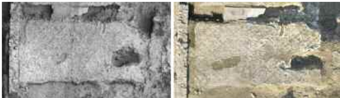
Figura 17 Porzione dell'immagine di profondità della domus (sinistra), nuvola di punti colorata (destra)
